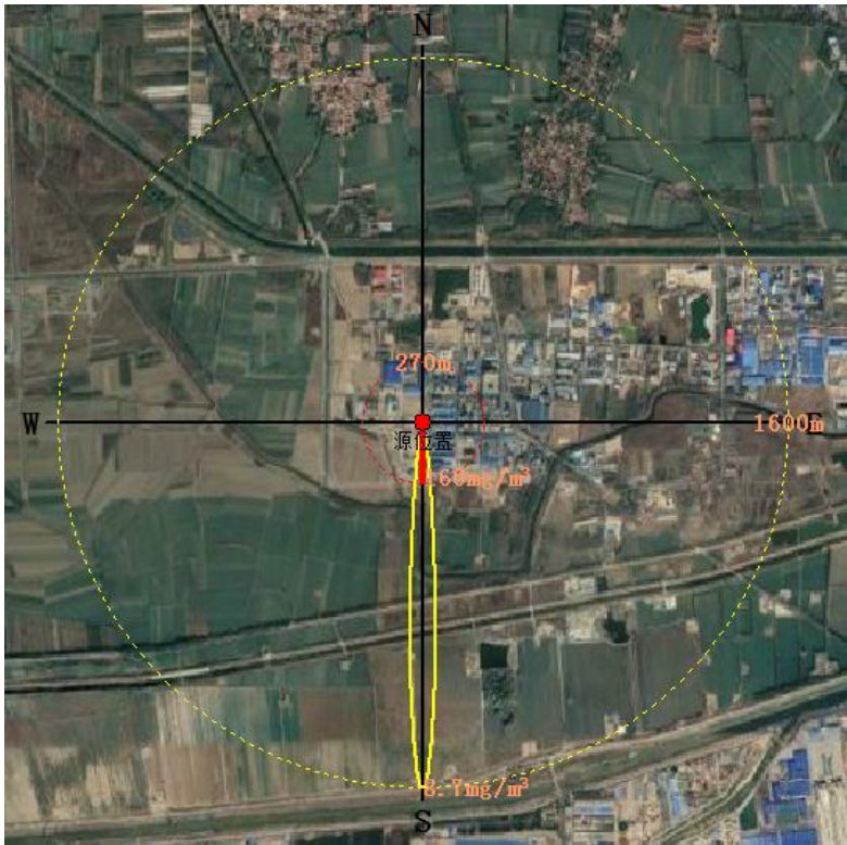
图 6-4-2 SO 3 泄漏事故最不利气象影响区域图(黄线:终点浓度 2; 红线:终点浓度 1)
