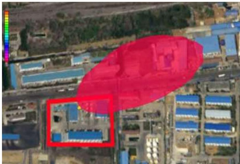
图 5.4-17 短期泄漏 100d 后氯离子在地下水中污染范围示意图
