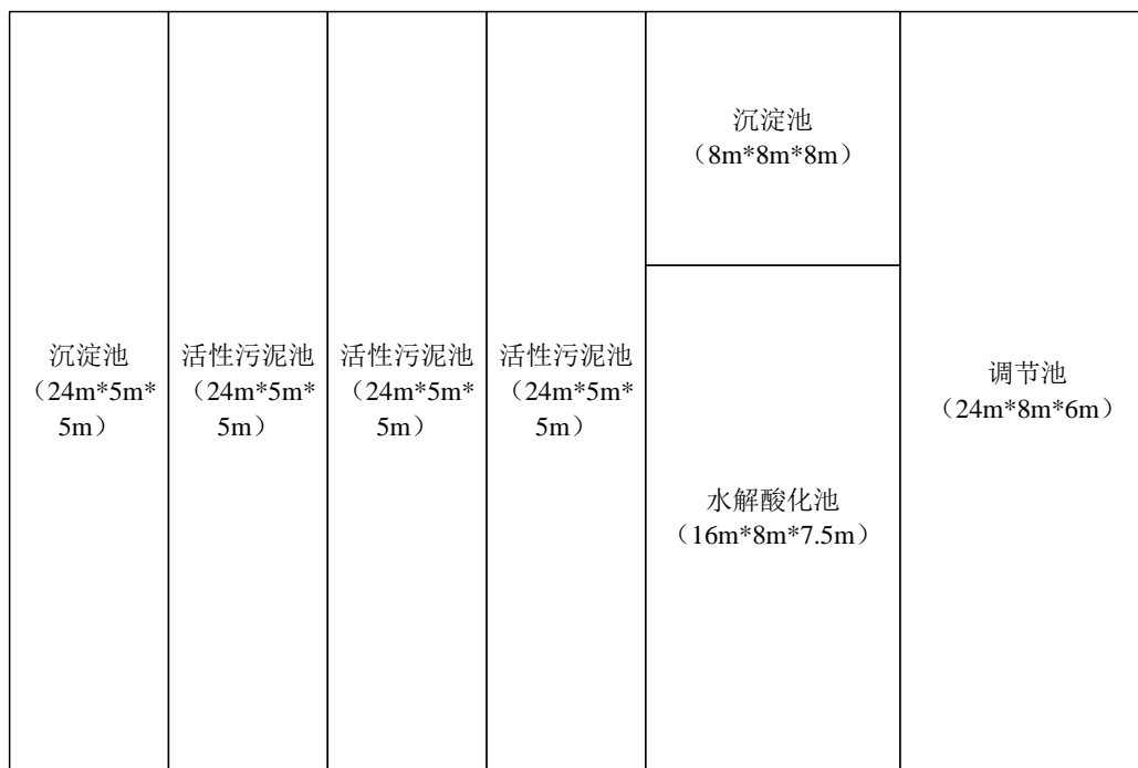
图 3.8-2 2000m 3 /d 污水处理站平面布置图
